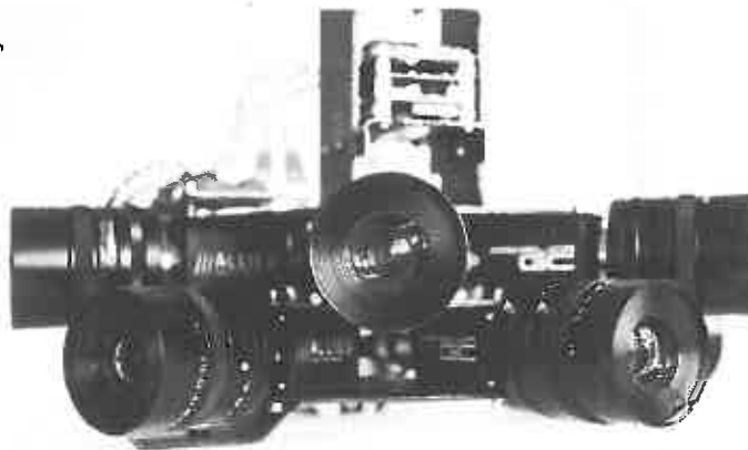
Das von Aerospy entwickelte Kamerasystem für Drohnen, bestehend aus sechs Kameras und einer Spezialbrille, ermöglicht (vom Boden aus) einen 220-Grad-Blick, wie wenn man den Kopf drehen würde. Nur zu groß ist es noch
